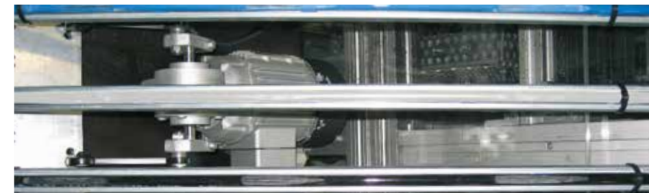
igus® material abrasion test
